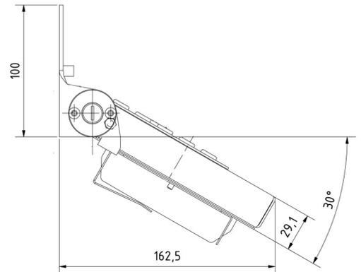
Gekapseltes Gehäuse, rundum IP65 mit dichter Kabeldurchführung an der rechten Seite. Anklappbar mit Hartgummianschlag. Tastatur, Touchpad und RFID-Reader über internen USB-Hub geführt. Die Technologie des optionalen RFID-Readers bestimmt der Bedarf, Legic, Mifare, Hitag usw.
